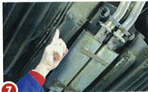
7 Aufgesetzt: Auf der Hebebühne entdeckt: nach unsanftem Bodenkontakt verbeultes Blech und Kraftstoffleitungen am Mercedes.
