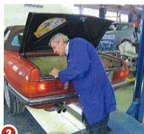
**2** Lichttest: Funktionieren alle Glühlampen? Auch ein Blick ins Gepäckabteil auf Wassereintrich schadet nicht. Sonst droht Rost im Heck.
