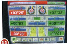
11 Eingestellt: Nichts für Selbstermacher: Spur und Sturz der Achsen können nur von Profis geprüft und gegebenenfalls justiert werden.
