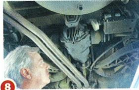
8 Alles dicht? Die elektrische Kraftstoffpumpe und ein Benzinfilter sitzen beim R107 neben dem Differentialgetriebe der Hinterachse.
