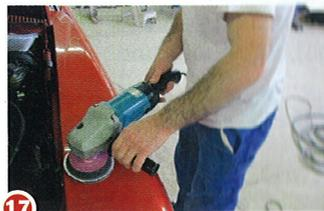
**17** Geschliffen: Selbst Kratzer, die fast auf die Grundierung gehen, können mit den entsprechenden Mitteln von den Lo.Re-Lackexperten beseitigt werden.
