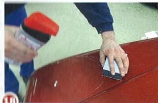
**18** Aufpoliert: Oberflächliche Riefen polieren die Fachleute mit abrasiven Lackpolituren in aufwendiger Handarbeit oder mit der Schleifmaschine einfach weg.
