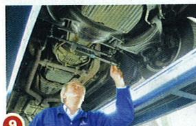
9 Abgelenkt: An schweren Wagen wie dem SL im Alter oft gebrechlich: Lenkungsämpfer und Spurstangen nebst Kugelgelenken.
